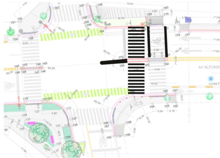
Figura 9. Recomendación de señalamiento horizontal sobre Av. Alfonso Reyes
