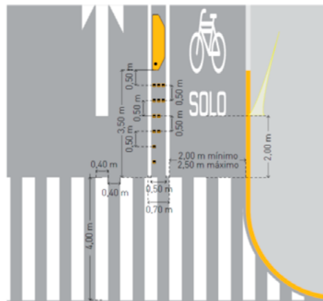
Figura 6. Recomendación para instalación de botones reflejantes
